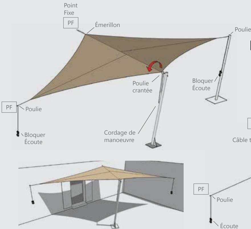
Principe de fonctionnement pour une voile double EMMAGASINEUR
